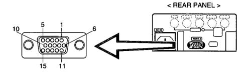
Pin assignments of 15-pin mini D-sub connector
